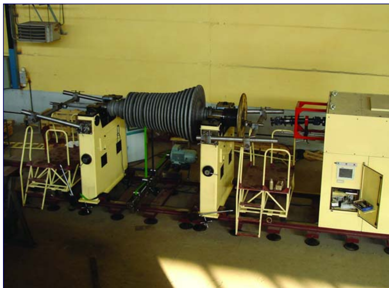
Балансировочный станок ВМ-36000 с дополнительным ременным приводом
