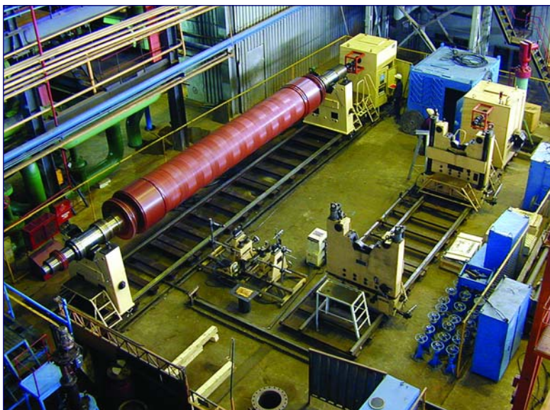
Участок балансировки Сургутской ГРЭС-2. Балансировочные станки VM-90000, VM-36000, VM-3000
