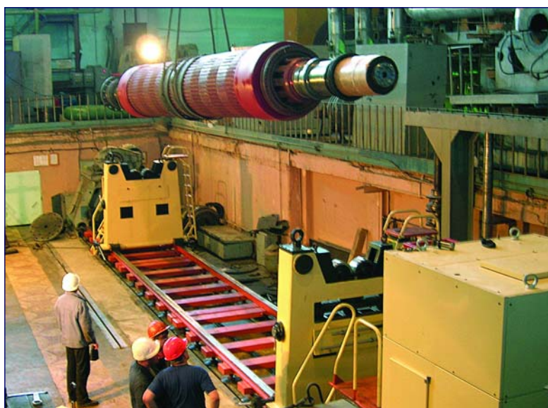
Балансировочный станок модели ВМ-65000, введенный в эксплуатацию на Кармановской ГРЭС в 2007 году позволяет выполнять балансировку всех типов турбинных и генераторных роторов (массой до 65 т.) оборудования ООО "БГК", включая ротор генератора ТВВ-320. Применение данного станка позволило значительно снизить количество балансировок в собственных подшипниках на этапе ввода оборудования после ремонта.
