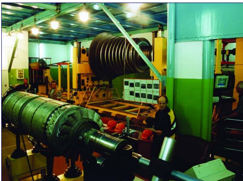
Участок балансировки роторов на Сургутской ГРЭС-1, балансировочные станки ВМ-36000, ВМ-8000, ВМ-1000.
