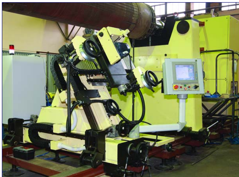
Полуавтоматический токарно-шлифовальный комплекс с компьютерным управлением для механической обработки поверхностей ротора с устройством для автоматического контроля биений ротора.
